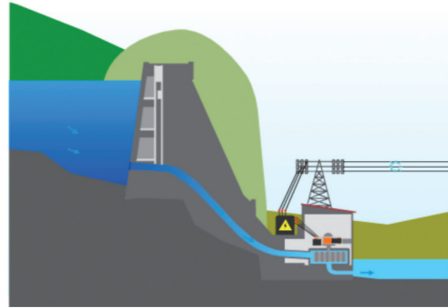
Esquema de una central hidroeléctrica
